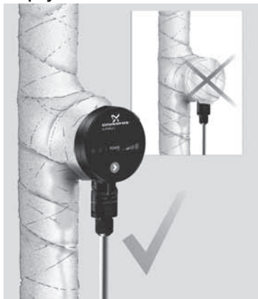
Рис. 6 Изоляция корпуса насоса
