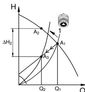
**Рис. 8** Насос в режиме управления по пропорциональному давлению
