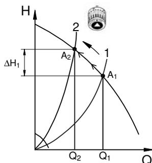
**Рис. 7** Нерегулируемый насос
